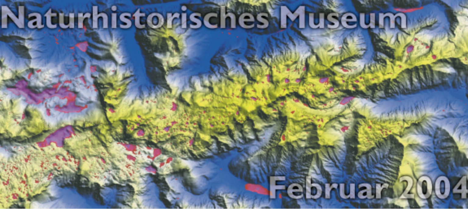
Digitales Geländehöhenmodell des Hochschwabplateaus, schattiert und eingefärbt nach Seehöhe (tief – blau, hoch – gelb); in rot sind geschlossene Hohlformen dargestellt. Datengrundlage 20-m-DGM des BEV.
