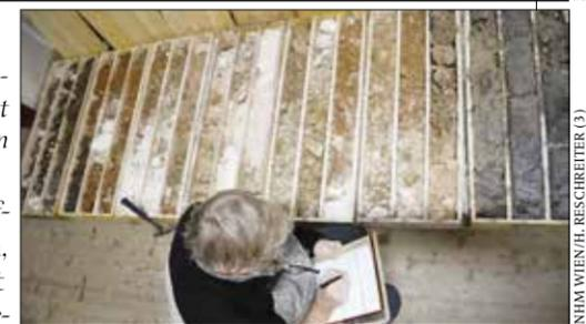
ob diese sich mit den Unterbrechungen der prähistorischen Bergbaue korrelieren lassen, wurde auf Grundlage der Messergebnisse im oberen Teil des Tales am Schnittpunkt des langen Längsprofils und eines Querprofils eine geologische Bohrung angesetzt.
