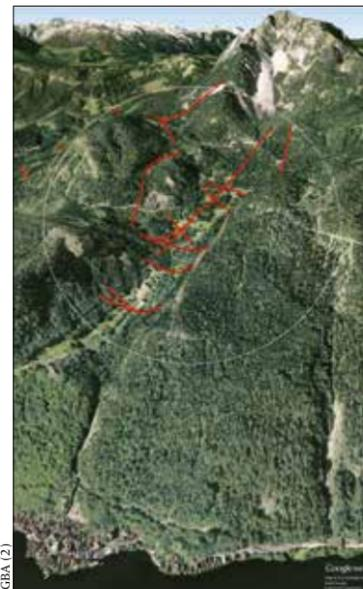
Lage der geoelektrischen Profile und die dazugehörigen Ergebnisse im Hallstätter Hohtal von 2013 bis 2017. Die roten Bereiche werden größtenteils den Rutschmassen zugeordnet.
