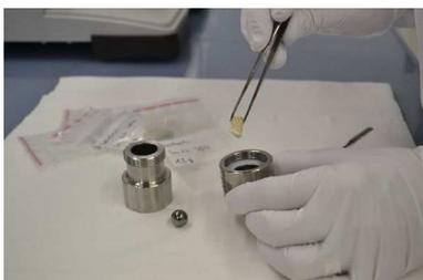
DNA-Extraktion mittels Kugelschwingmühle: Eine Knochenprobe wird in eine Wolframcarb-Mahlbecher überführt. Mittels Wolframcarbkugeln und Schütteln bei hoher Frequenz wird der Knochen in der Folge pulverisiert. Dies ist dann das Ausgangsmaterial für die DNA-Extraktion.
