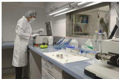
DNA-Extraktion im Reinraum (Kugelschwingmühle rechts im Vordergrund).
