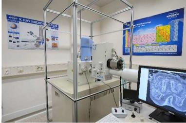
Rasterelektronen-Mikroskop: Seitenansicht des Geräts
