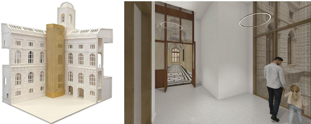
Abbildung 32: Entwurfsplanung für den Lift im ersten Hof; links: Außenansicht, rechts: Austrittssituation in die obere Kuppelhalle; Grafik: Hoskins Architects 2023
