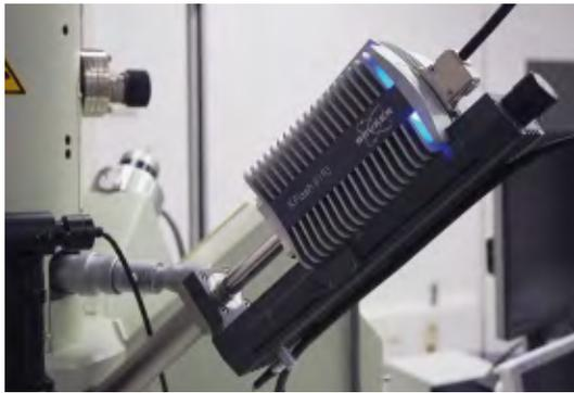
Energiedispersiver Detektor der Elektronenstrahlmikrosonde.
