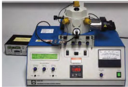
Mit der Ionenstrahlätzenanlage werden Proben für die EBSD-Technik aufbereitet.
